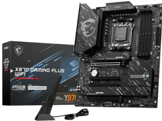
Speicher: 4x DDR5 (max.192GB DDR5), Anschlüsse: 4x M.2, 4x SATA 6Gb/s Chipsatz: AMD X870, AM5, Sound: Realtek ALC4080 7.1, Netzwerk: Realtek 8126-CG 5G LAN
