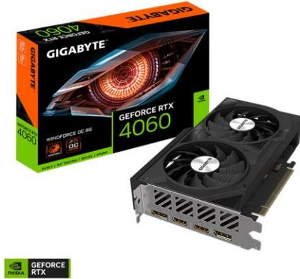
PCI-Express 4.0 (x16), Speicher: 8GB GDDR6, Anschluß: Display-Port1.4a, HDMI2.1 Chipsatz: NVIDIA GeForce® RTX 4060, DLSS3
